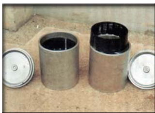
Foto 3 – Dispositivo de Ensaio de Tração Direta Desenvolvido por Leroy (Engenheiros de FURNAS, 1997)
